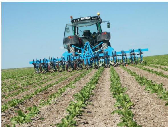
Désherbage mécanique combiné avec bineuse Monosem et moulins Kress
